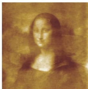
通过刮擦聚碳酸酯形成的纳米刻蚀图 20 μm 扫描
