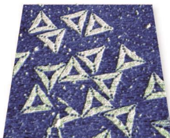
DNA折纸三角： 液体成像，每个边长约120 nm，600 nm扫描。感谢加州理工学院的P.W.K. Rothemund提供样品。
