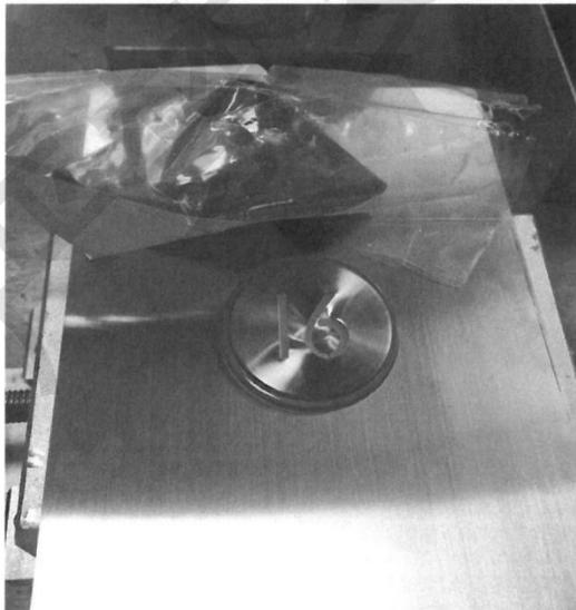
图 2 冲击试验后样品照片
