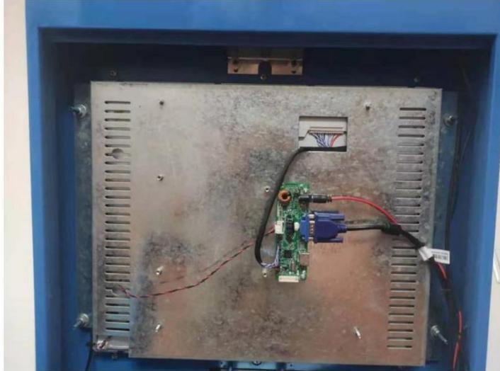
内部结构 (显示屏驱动板)
