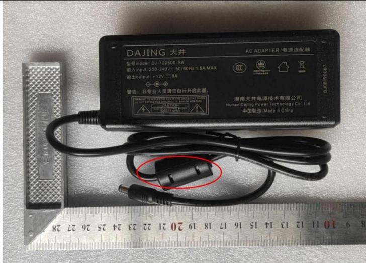
电源适配器铭牌 (型号: DJ-120800-SA) (给计算机模块供电)
