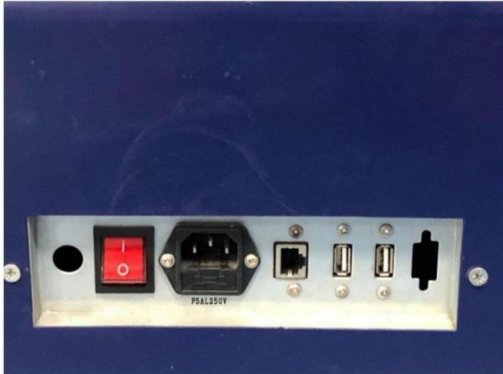
器具输入插座位置、翘板开关、USB端口、网口
