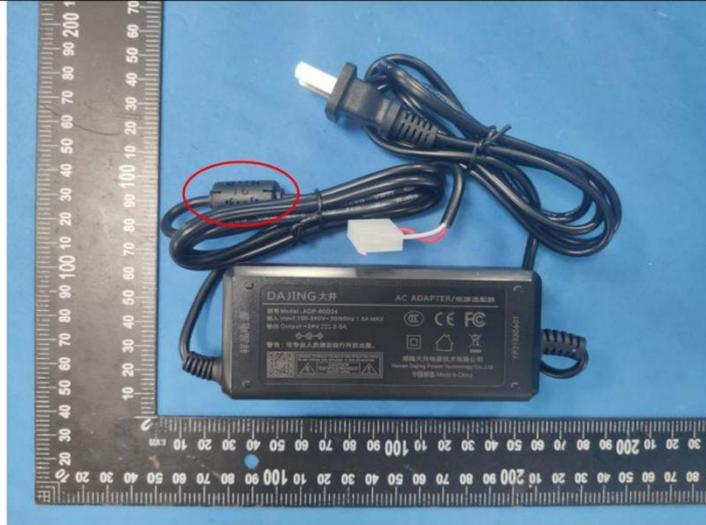
电源适配器铭牌 (型号: ADP-60D24) (给热敏打印机模块供电)
