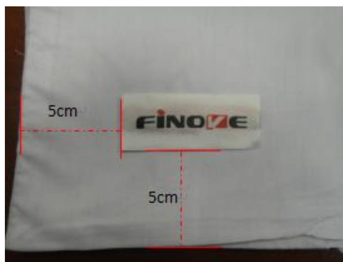
图 3 枕套标签缝制示意图
