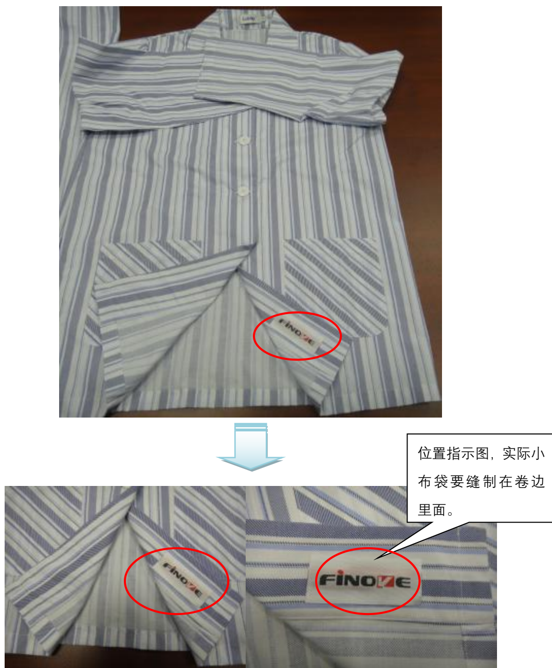
图 4 病衣标签缝制示意图
