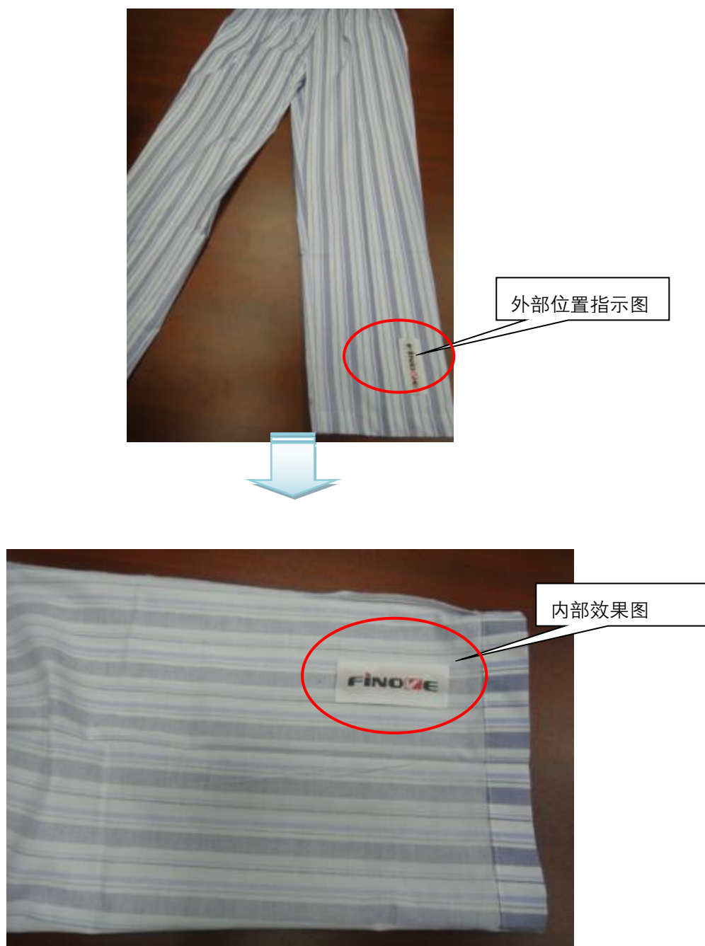
图 5 病裤标签缝制示意图
