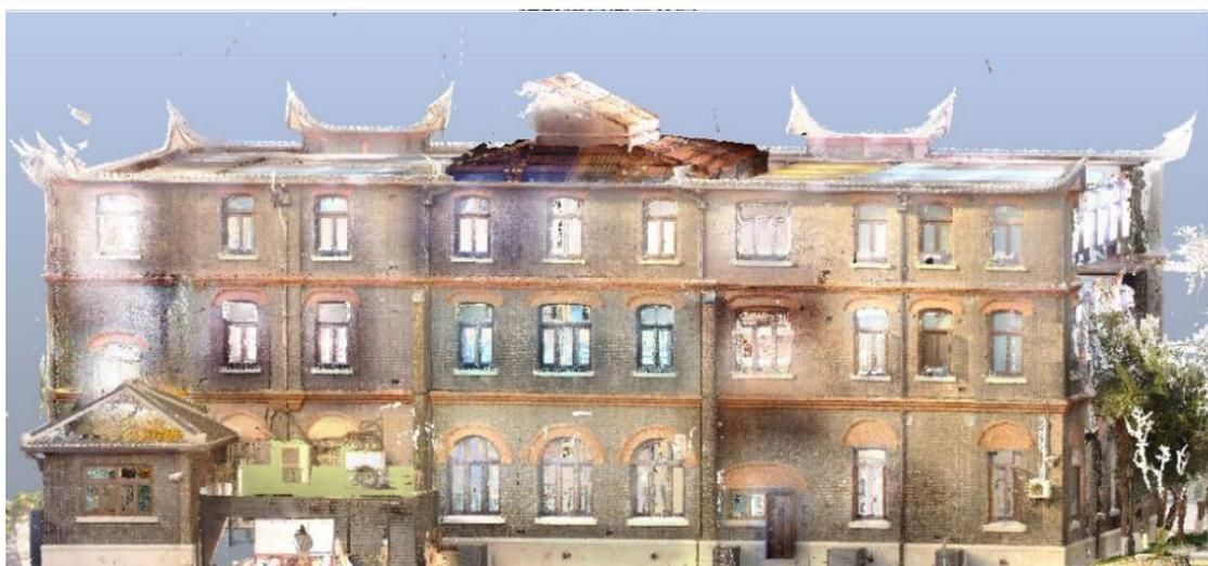
建筑三维激光点云模型
