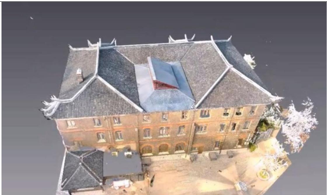
三维激光点云模型与无人机航拍点云融合
