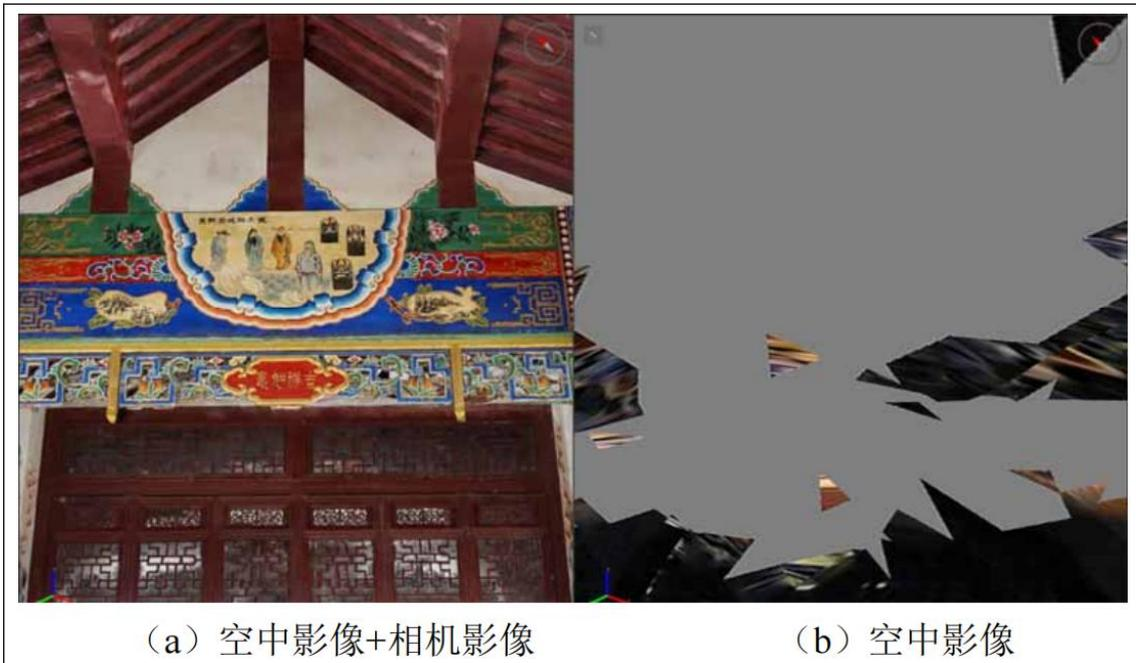
根据图对比可知：在走廊底部的廊道区域，仅无人机影像构建的模型由于分辨率太低、重叠度不足等原因出现了纹理拉花和模糊等现象，融合相机影像后构建的模型在地面砖块和侧面护栏等区域表现更加清晰真实，几何结构更加完整准确，纹理更加真实细腻。
