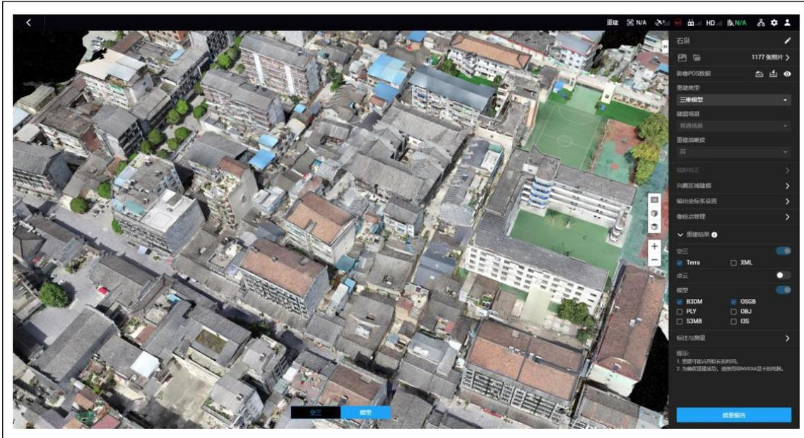
数据重建将无人机倾斜摄影测量进行倾斜摄影获取的影像，手控飞行及地面拍摄的影像通过专业软件如大疆智图或者 CC 软件进行处理，生成真三维实景模型数据成果，并对真三维模型成果进行优化。
