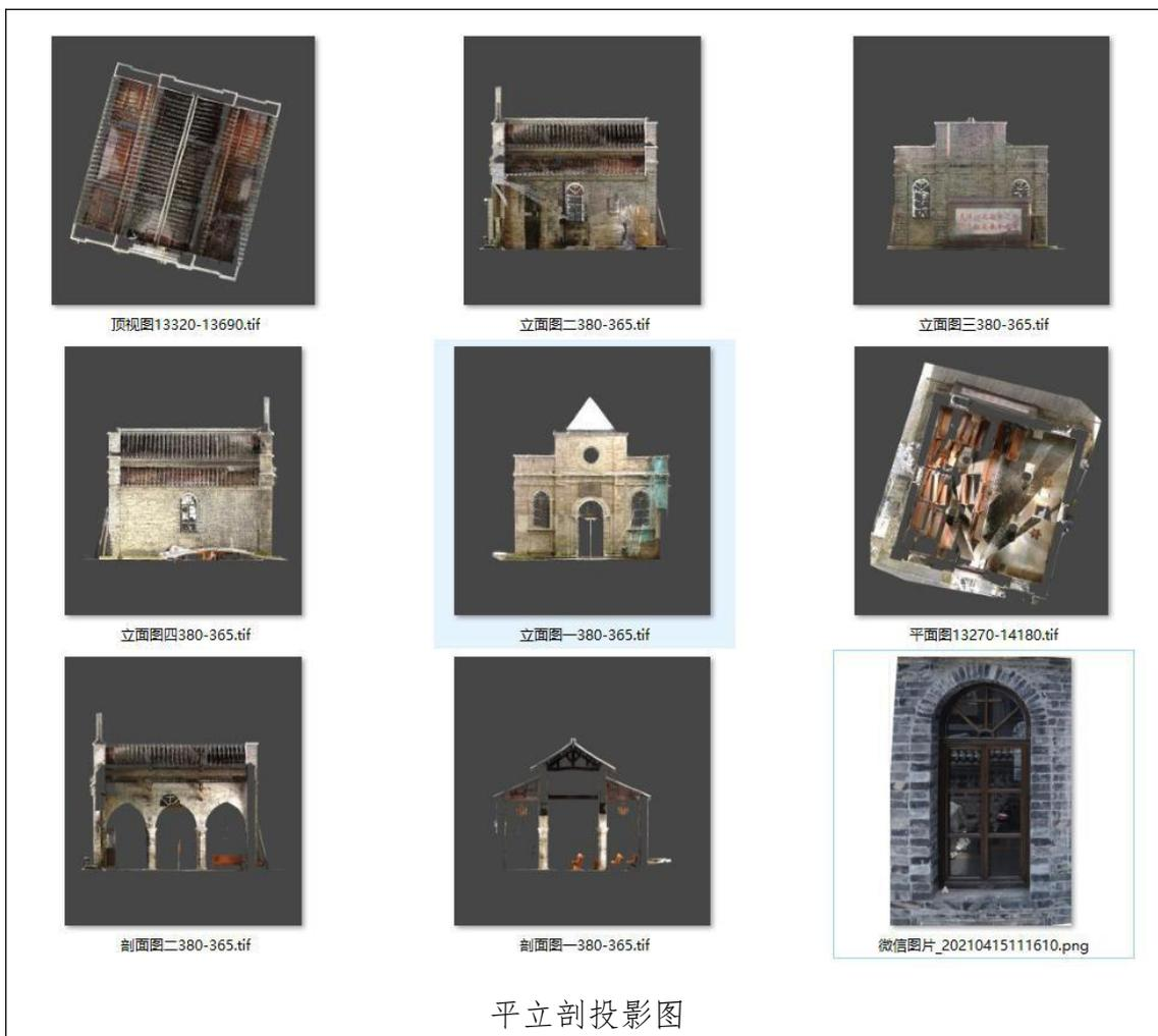
大样图选取历史建筑具有典型性、符号特征的建筑细部，采用照片展示。绘图比例为 1: 10 或 1: 25。如下图为历史建筑点云数据矢量化还原的立面图、剖面图、大样图。
