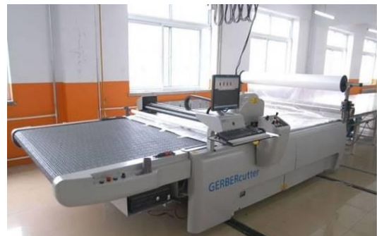
格柏自动裁床 ( 服装 CAM 系统 )
