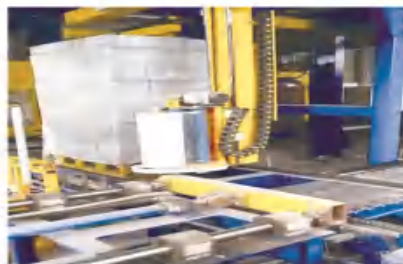
引进德国无托盘打包 生产技术对成品砖覆膜打包
