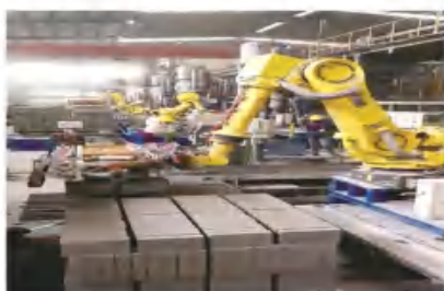
生产线采用日本法纳科 工业智能机器人进行自动化生产
